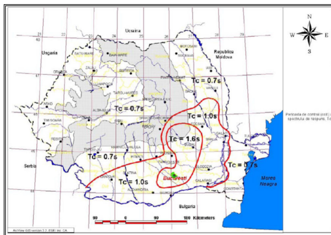
Fig. 5: Zonarea teritoriului Romaniei in termeni de perioada de control (colt), T_C a spectrului de raspuns
