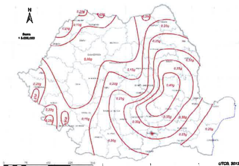
Zonarea valorilor de vârf ale accelerației terenului pentru proiectare ag cu IMR = 225 ani și 20% probabilitate de depășire în 50 de ani
